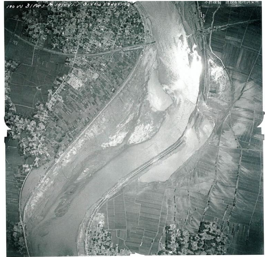
121. 航空写真(九頭竜川中流域 国鉄北陸線九頭竜川鉄橋付近) 昭和23年(1948) 国土地理院ウェブサイト( http://www.gsi.go.jp/ ) 昭和23年7月28日に撮影されたもの。中角付近から東(上流側)を望む九頭竜川の堤防が南岸で決壊している。
