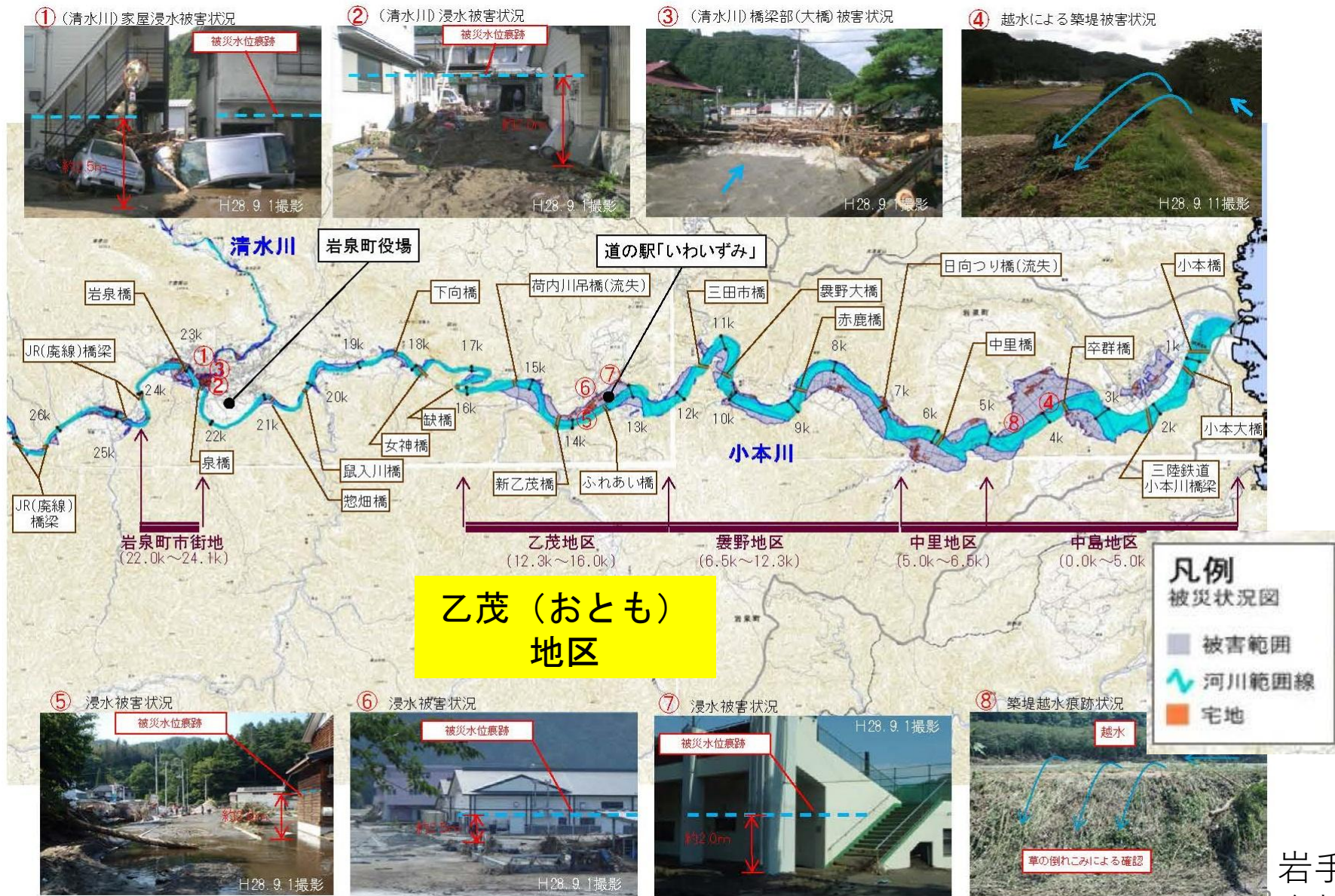
図 4.1.4 小本川 浸水被害 激特區間(0.0~24.1k)
